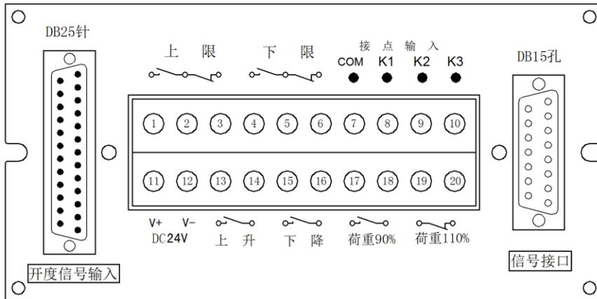
用于卷扬启闭机后面板布置示意图 (五路接点输入)
