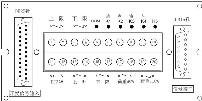
**用于螺杆闭机后面板布置示意图（三路接点输入）**
