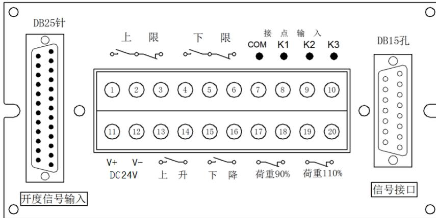
**用于螺杆闭机后面板布置示意图（五路接点输入）**
